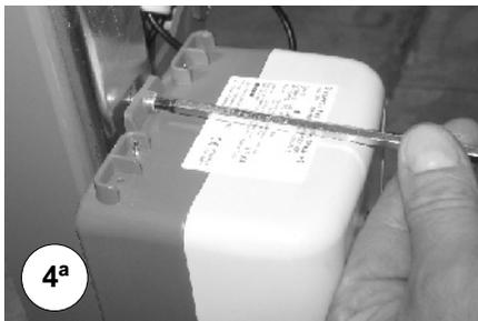
Fig. 4<sup>a</sup> - Befestigen Sie jetzt die vorher gelösten Schrauben wieder. (s. fig. 2<sup>a</sup>).
